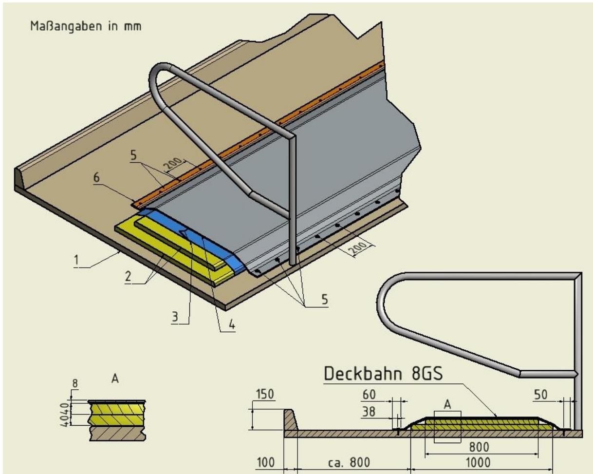
Legende: 1 Beton, 2 Verbundschaum, 3 Folie, 4 Deckbahn 8GS, 5 Befestigung, 6 Winkelleiste
