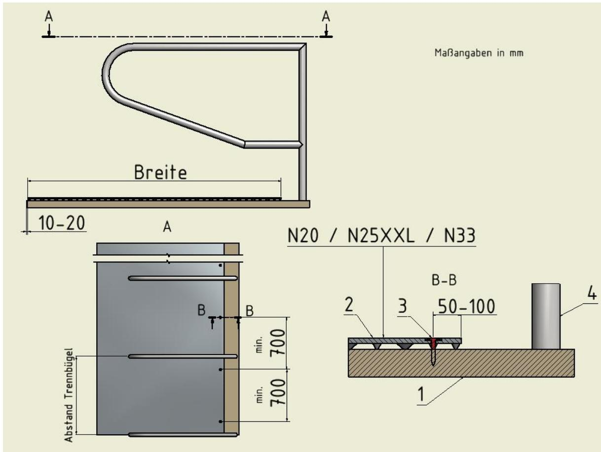
Legende: 1 Beton, 2 Gummibelag N20/N25/N33, 3 Befestigung, 4 Trennbügel
