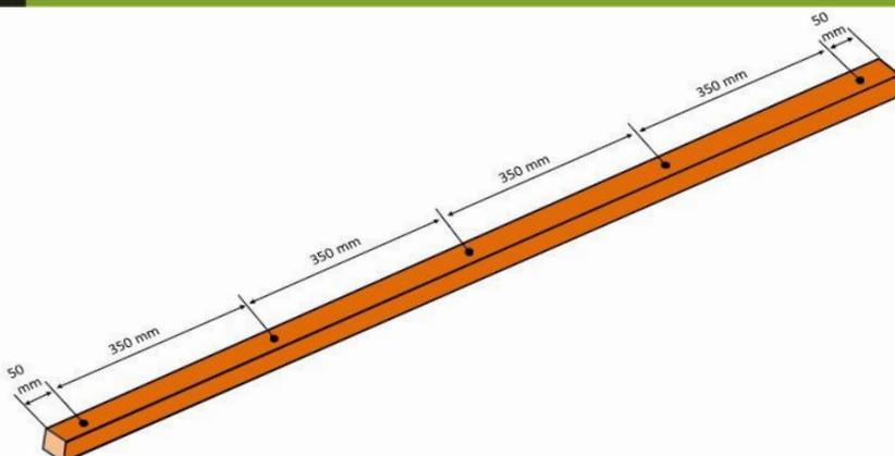
Löcher mit einem Durchmesser von 10 mm an die angegebenen Positionen in die Kunststoffleiste bohren falls nötig
