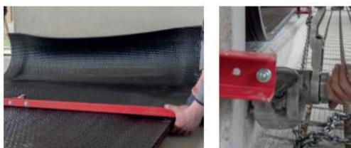
Die Deckbahn muss um 1,0 -1,5 % (1 % entspricht 10 cm pro 10 m) vorgespannt werden.
