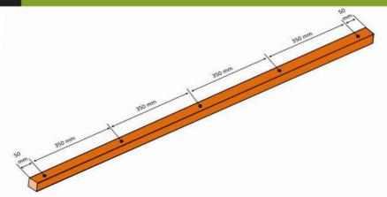
Löcher mit einem Durchmesser von 10 mm an die angegebenen Positionen in die Kunststoffleiste bohren falls nötig
