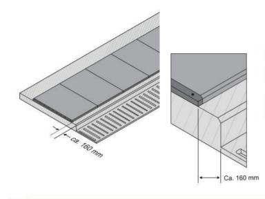
In den beiden Stirnbereichen werden die 1500 mm langen WINGS-Kunststoffleisten befestigt.
