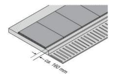
Die in Folie verpackten Verbundschaumplatten mit einem Abstand von ca. 160 mm zur hinteren Betonkante auslegen.
