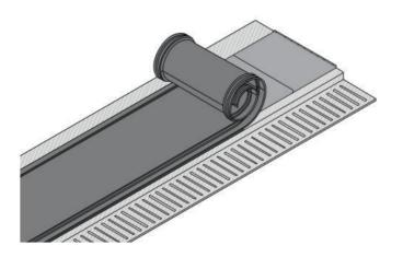
**Hinweis:** Sollte sich die Deckbahn aufgrund der Aufstallung nicht über die Platten ausrollen lassen, kann die ausgerollte Bahn auch in Position gezogen werden. Dabei muss darauf geachtet werden, dass die Folie nicht beschädigt wird. Die Position der Verbundschaumplatten sollte anschließend überprüft werden.
